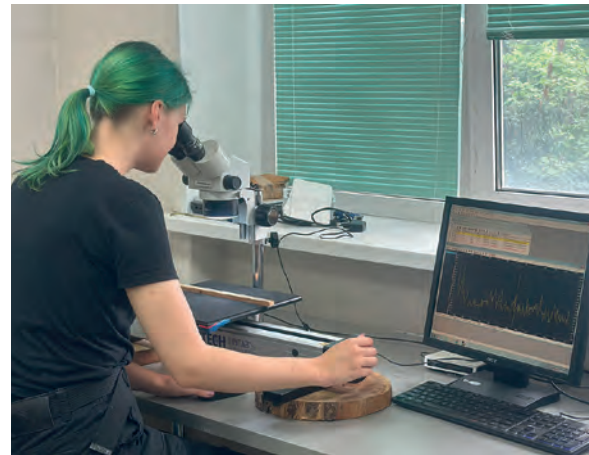
Устройство Lintab упрощает работу по измерению параметров древесных годичных колец при дендро-климатических исследованиях
