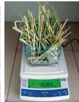
Аналитические весы позволяют точно определять биомассу
