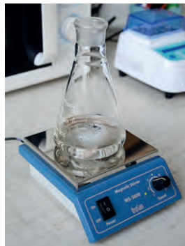
Магнитная мешалка для подготовки агарозного геля, используемого для проведения электрофореза. Фото К.Г. Климовой
