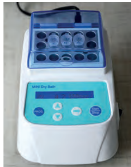
Термостат для отделения выделенной ДНК от белков и полисахаридов путем охлаждения в присутствии буферного раствора. Фото К.Г. Климовой.
