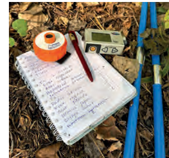
Базовый набор инструментов: ультразвуковой высоотомер, полевой дневник, возрастные бурава
