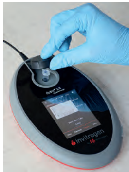
Загрузка материала в флуориметр настольный Qubit для измерения концентрации выделенной ДНК. Фото К.Г. Климовой
