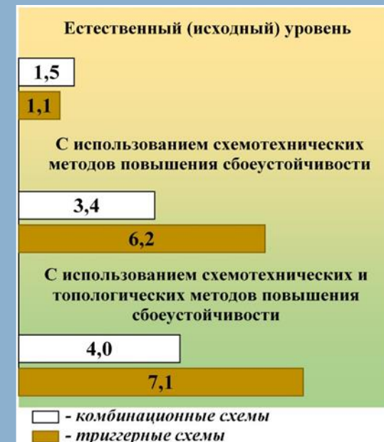
Рис. 2. Преимущество СС-схем в сравнении с синхронными аналогами по уровню сбоеустойчивости
