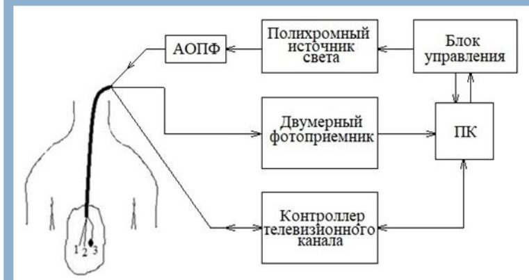
Рис. 2. Структурная схема макета гибридного эндоскопа для диагностики рака внутренних органов на основе многоспектрального анализа
